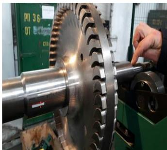
**Рис. 1. Диск рабочего колеса радиальной турбины**
